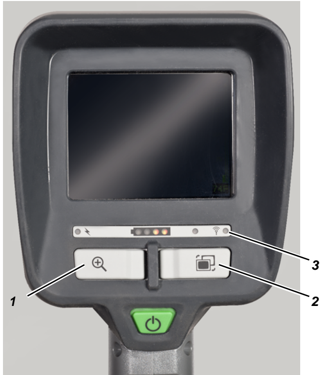
Fig. 7 Botones adicionales de las cámaras EVOLUTION 6000+ y 6000 X
