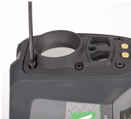
Fig. 17 Tornillos que deben retirarse del elemento de retención de la lente de germanio
